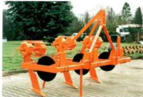
Untergrundlockerer für 2 Reihen. Erdbeeren oder 1 Reihe Spargel
