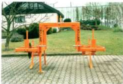
Untergrundlockerer für 2 Reihen. Erdbeeren oder 1 Reihe Spargel
