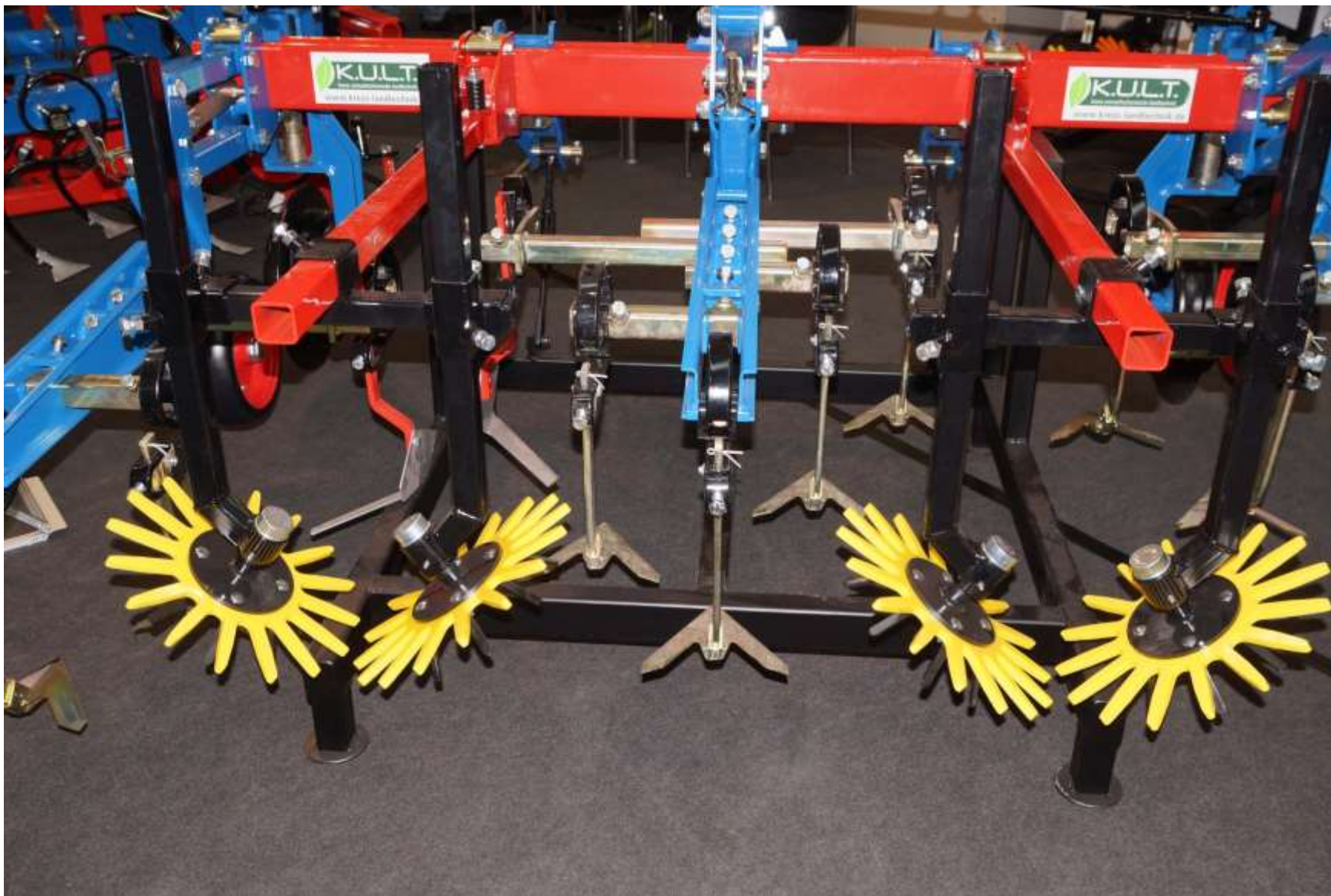
Prstová plečka. Plastové prsty jedou těsně u rostlin jahodníku a odstraňují šetrně plevel. V uličce mezi jahodami jedou šipky.
