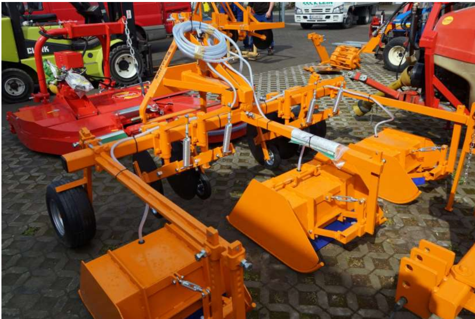
Postřikovač 3- kaslíkový, určený k postřiku uliček mezi jahodami přípravkem Basta. Vidíme kotoučové nože k odřezávání odnoží. Kaslíky jedou po lyžinách.
