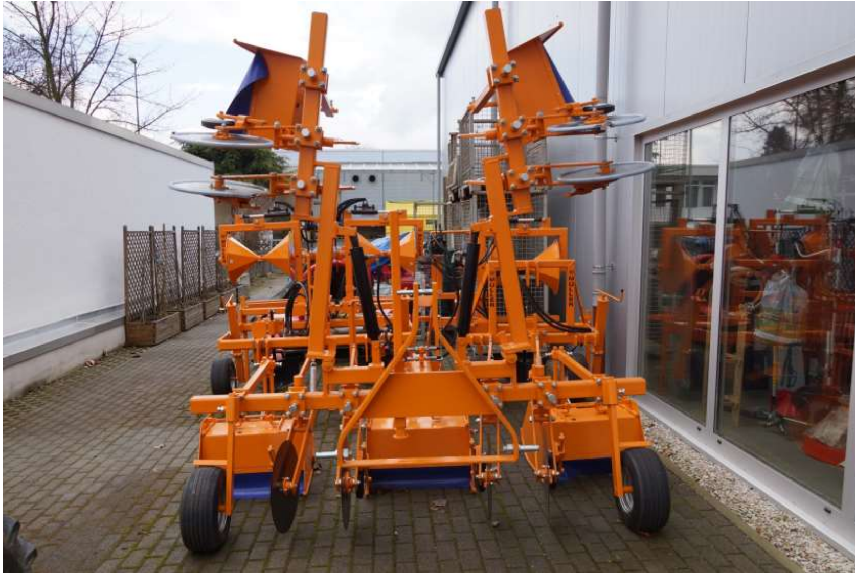
Postřikovač 5-kaslíkový s hydraulicky ovládanými rameny.
