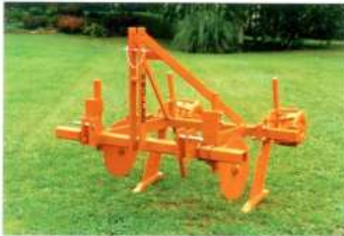
Untergrundlockerer 3 Reihen, Anbau: Normalschlepper Kat. 2
