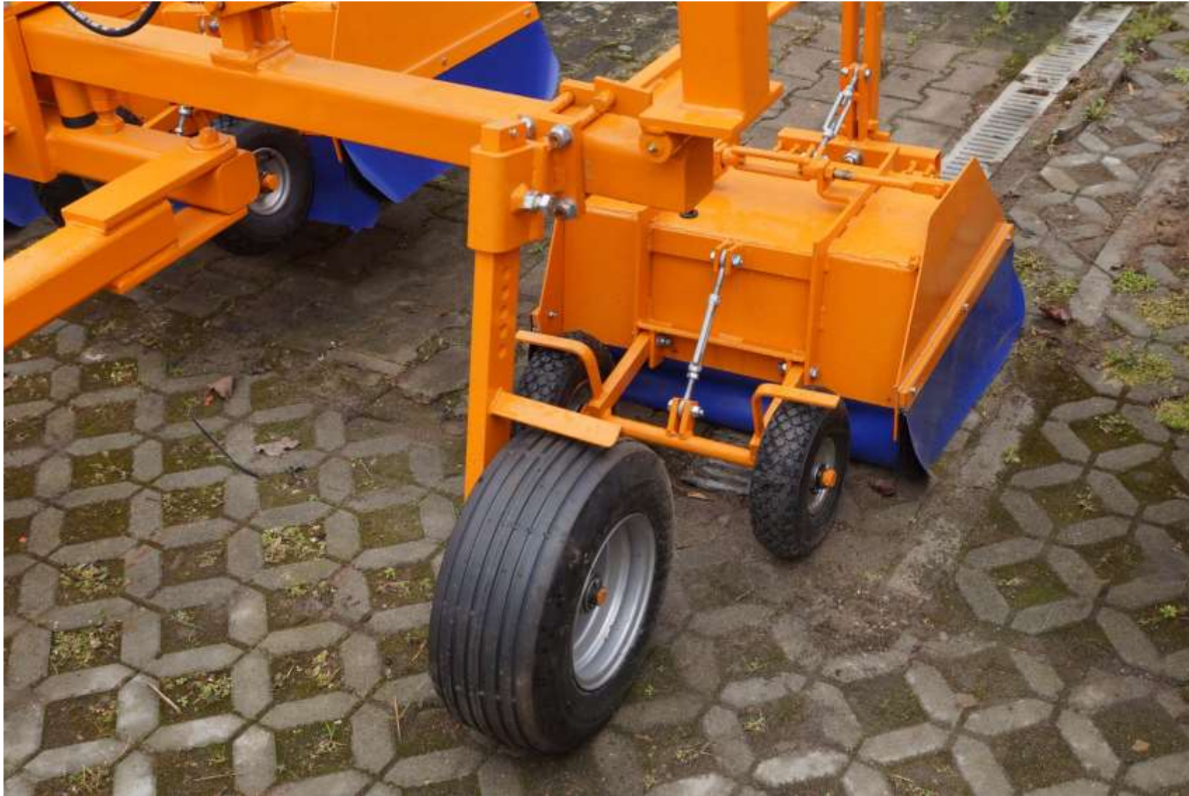
Detail uspořádání kaslíku. Tyto kaslíky nejedou po lyžinách, ale jejich výška nad zemí je nastavitelná.
